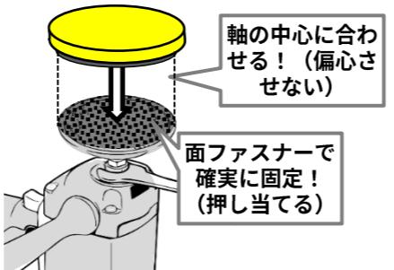
推奨電動工具：RYOBI PE-201への取り付け例
