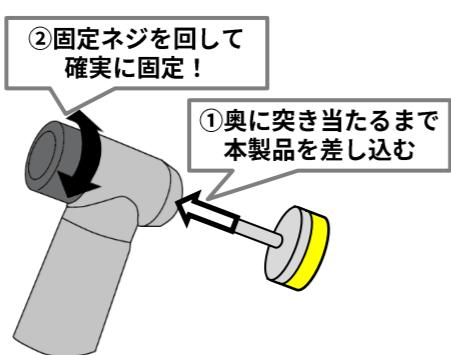
推奨電動工具：バンガードマイクログラインダー UCV900（当社製）への取り付け例
